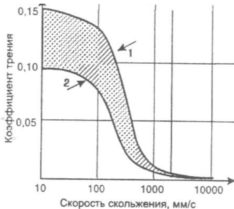
Рис 2. Зависимость коэффициент трения от модификатора трения: 1 - масло без модификатора трения; 2 - масло с модификатором трения
