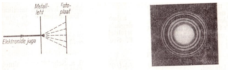
Joonis 35 Elektronide difraktsioon. ( Saveljev 1979, 239 ).
