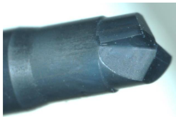
Abbildung 2.8: Durch tangentiale Laserbearbeitung gefertigter Mikrofräser [10]
