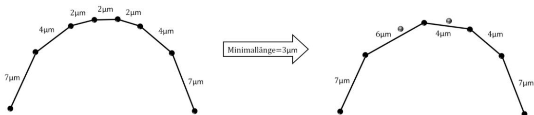
Abbildung 4.22: Überspringen von sehr kurzen Konturkanten
