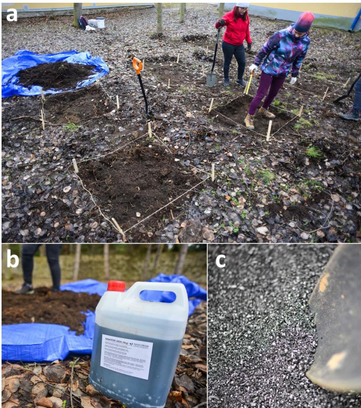
Obr. 2: Založení polních experimentálních ploch na lokalitě Huť – a) založení experimentálních ploch, b) suspenze SnZVI, c) železné piliny.
