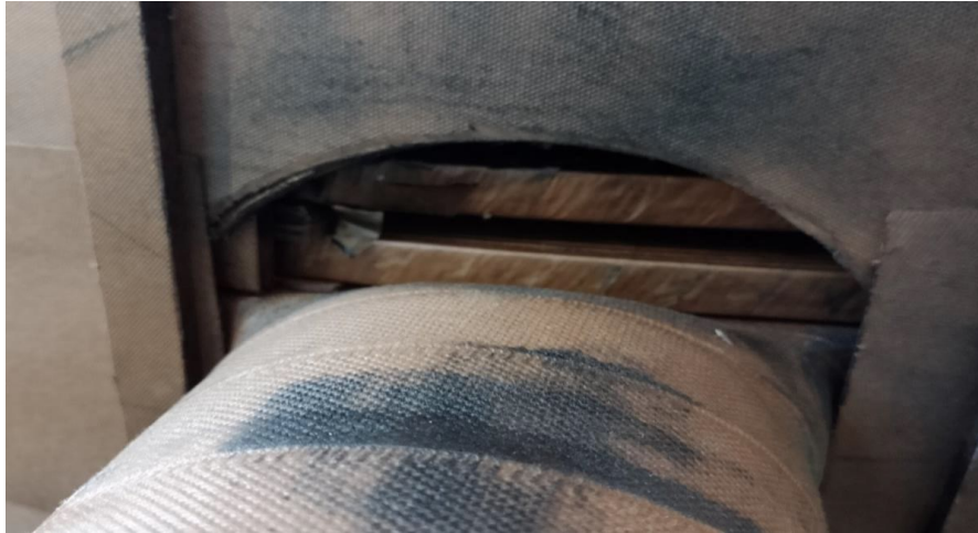
Slika II Kvar na fazi U visokonaponskog namotaja
