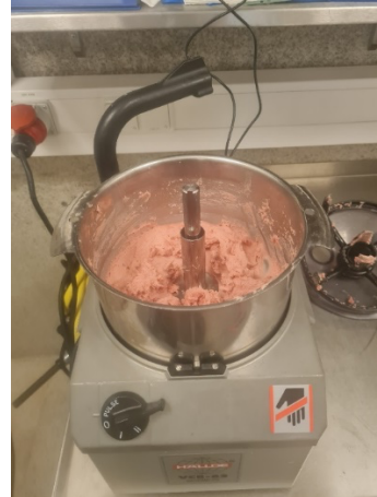
Mynd 7. Eftir blöndun í farsvél var blöndunni komið í blandara þar sem sýnið var gert einsleitt.
