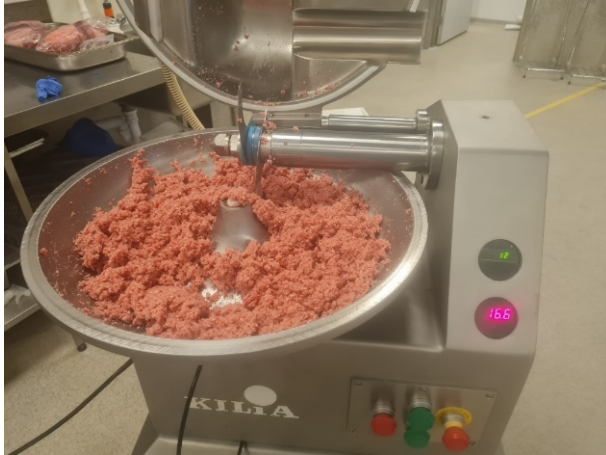
Mynd 6. Eftir hökkun í hakkavél var hakkinu komið í farsvél til frekari blöndunar.
