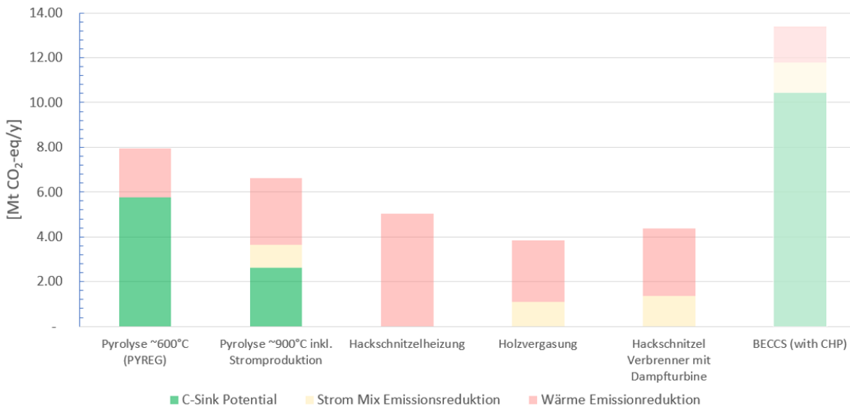
Abbildung 2: Energetische und CO 2 -negative Verwertung des jährlichen Biomassepotentials in der Schweiz für verschiedene Technologien zur Verwertung von verholztem Ausgangsmaterial (BECCS ist hell schattiert, da Transport und Speicherung heute noch ungelöst ist und das Potential reduzieren wird).
