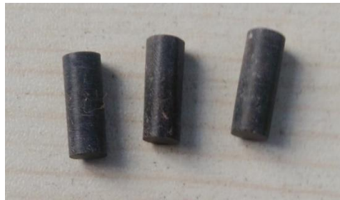
Şəkil 1. Sürtünmə sınaqlarında istifadə edilən silindrik nümunələr
