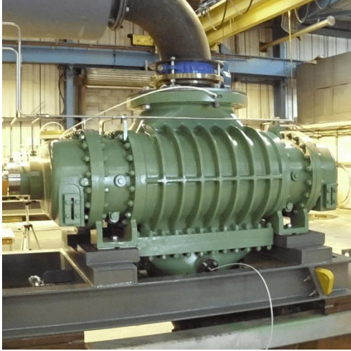
Şəkil 2. Məşəl qazlarının təkrar emal üfürücü kompressorları.
