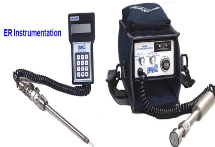
Fig. 8-8. ER measuring devices.
