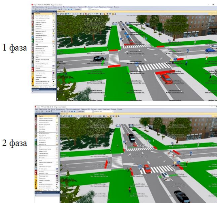
Рисунок 15 – Фрагмент моделювання при запропонованій 3 схемі ОДР на перехресті вул. Миру – просп. Архітектора Альошина
