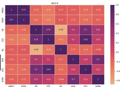
Figura 3. Grado de correlación entre las diferentes variables: resistividad eléctrica (RMED, RDEP), radiación gamma natural (GR), inversa de Vp (DTC), sedimento base (BS), velocidad de penetración (ROP), inversa de Vs (DTS) y promedio de la velocidad de penetración (ROPA)
