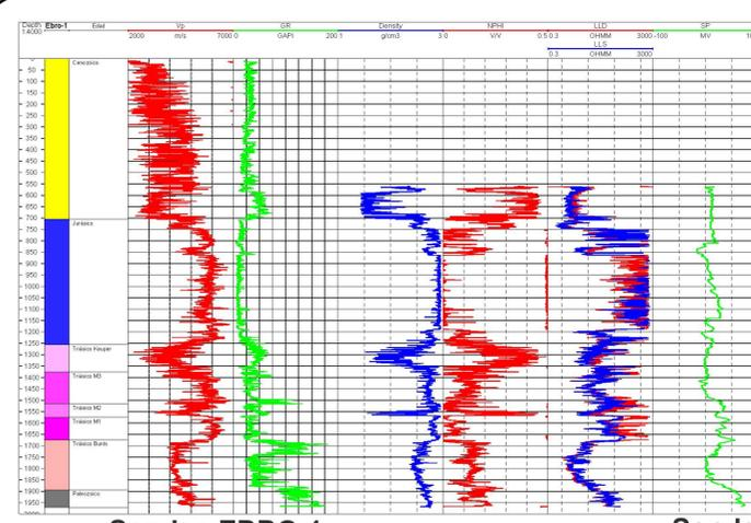
Figura 7. Edad geológica de los materiales atravesados en el sondeo EBRO-1 y diagráfías medidas. De izquierda a derecha: Vp, gamma natural, densidad, porosidad, resistividad corta y larga y potencial espontáneo
