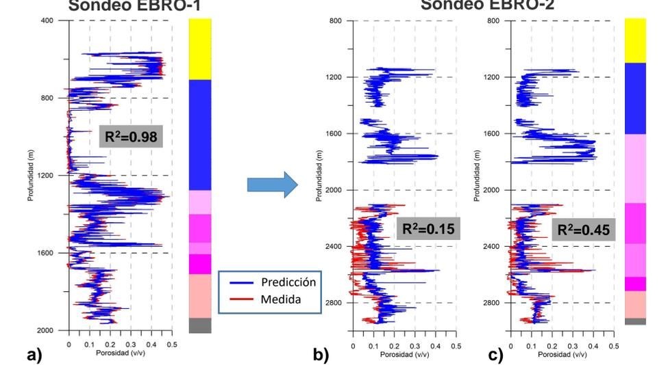
Figura 8. a) Sondeo EBRO-1: porosidad medida (rojo) y predicha (azul) mediante el algoritmo ADABOOST utilizando como diagráfías de entrada: Vp, GR, SP, Caliper y resistividad eléctrica b) Porosidad calculada en EBRO-2 utilizando el modelo obtenido para EBRO-1. Los datos de entrada no han sido normalizados. c) Igual que b) pero con los datos de entrada normalizados y suavizados con una media móvil.
