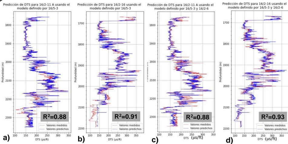
Figura 4. Predicción de DTS en dos sondeos de Volve (16/2-11 y 16/2-16): a) y b) a partir del modelo obtenido en un único sondeo (16/5-3), c) y d) a partir del modelo obtenido utilizando dos sondeos (16/5-3 y 16/2-6).
