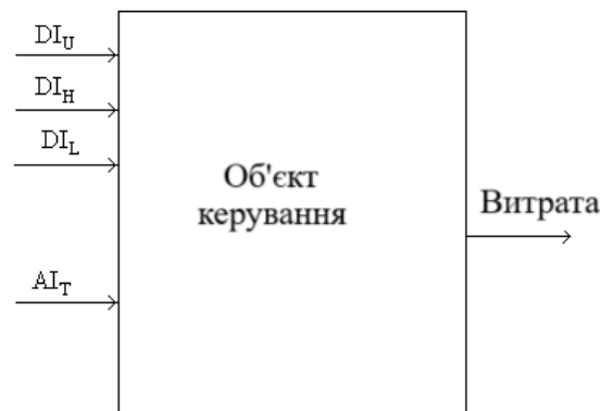
Рисунок 2 - Схема інформаційної структури маркера як об'єкта керування
