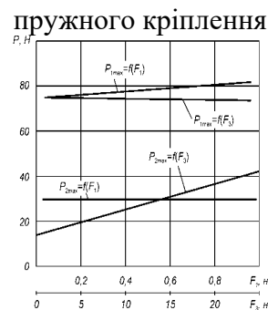
Рисунок 4- Залежність динамічних навантажень у в'язальній системі від технологічних навантажень F_1 і сили тиску (статичної) голок на клин F_3
