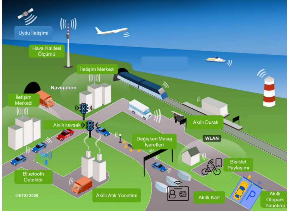
Şekil 1. Akıllı Ulaşım Sistemleri Bileşenleri (ETSI-ITS, 2023'ten uyarlanmıştır.)
