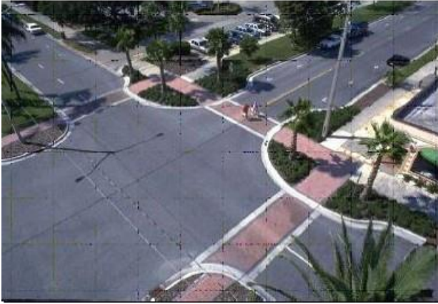
Şekil 5. Kaldırımın Genişletilmesi (https://highways.dot.gov/public-roads/janfeb-2010/risking-success-through-flexible-design)
