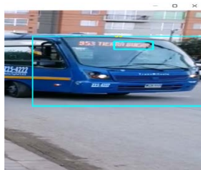
Figura 5. Resultado del entrenamiento para la identificación del bus SITP utilizando con Visión por Computador sin usar Deep Learning
