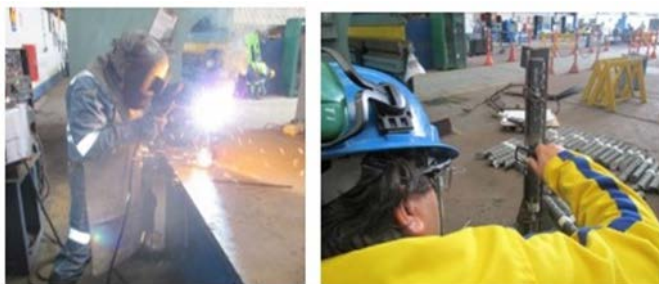
Figura 4. Soldeo e inspección visual de los ensambles de prueba
