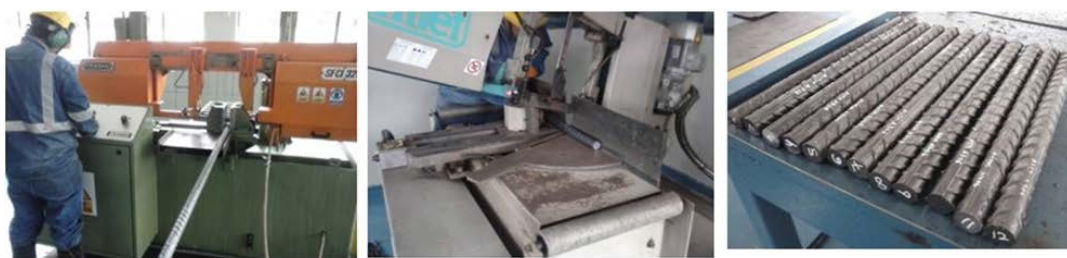
Figura 3. Corte para ensambles de prueba
