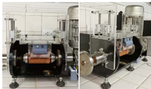
Figura 15. Segundo prototipo fabricado con sistema de desplazamiento por medio de rodamientos lineales.
