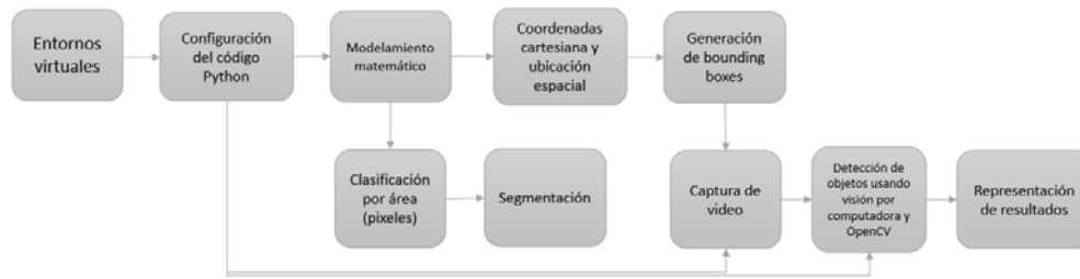
Figura 4. Esquema general de entrenamiento usado para el reconocimiento de imágenes con Visión por Computador sin usar Deep Learning
