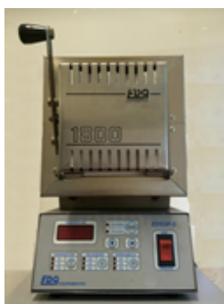
Figura 1. Horno utilizado para colar compuestos vítreos
