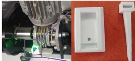
Figura 9. Montaje de sensor infrarrojo sobre eje motor del equipo de desgaste
