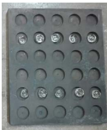
Figura 2. Molde de aluminio utilizado para el tratamiento térmico de las pastillas de 80MBO
