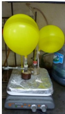
Figura 5. Montaje para la síntesis de PLLA de alto peso molecular
