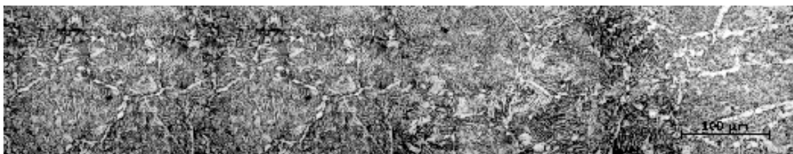
Figura 6. Distribución micro-estructural en la junta de soldadura del acero ASTM A 615
