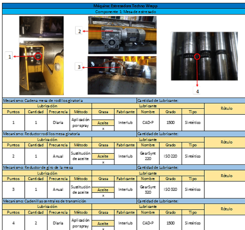
Figura 5. Carta de lubricación de la estresadora Techno Wrapp
