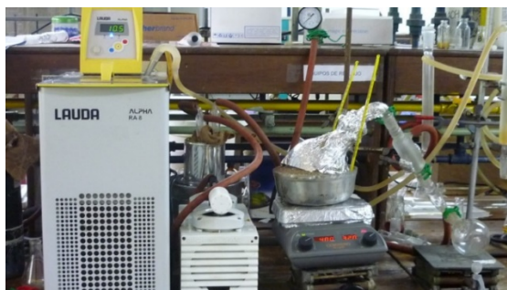
Figura 1. Montaje del equipo de destilación al vacío para la obtención del oligómero de PLLA
