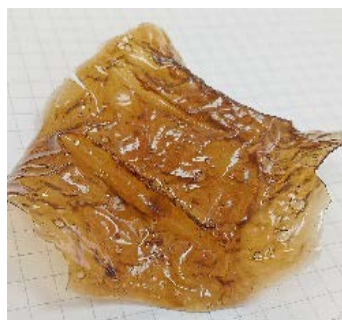
Figura 11. Lámina de bioelástomero obtenida a nivel de laboratorio
