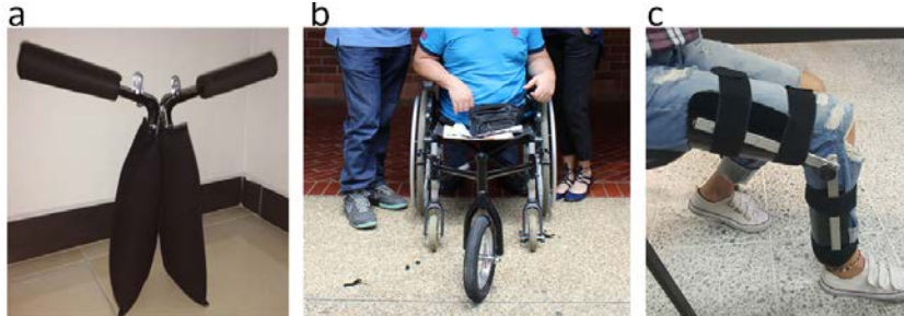
Figura 1. Proyectos DDB y DBAC: a) Dispositivo para facilitar la abducción del miembro inferior para personas con parálisis espástica. b) Adaptación de silla de ruedas para un usuario con amputación bilateral de cadera, para mejorar la estabilidad y movilidad. c) Dispositivo para mejorar la movilidad de una mujer con síndrome post-poliomielitis
