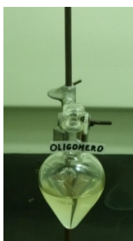
Figura 2. Oligómero de PLLA obtenido mediante policondensación
