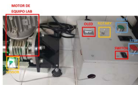
Figura 11. Vista de ensamble de panel de control en equipo de desgaste superficial
