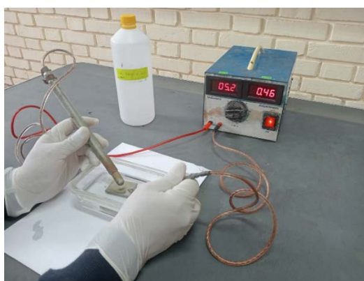
Figura 5. Ataque electrolítico del acero inoxidable de la parte interna de la olla
