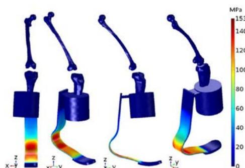
**Figura 10.** Esfuerzo Von Mises durante la postura media en una prótesis ESAR [29]
