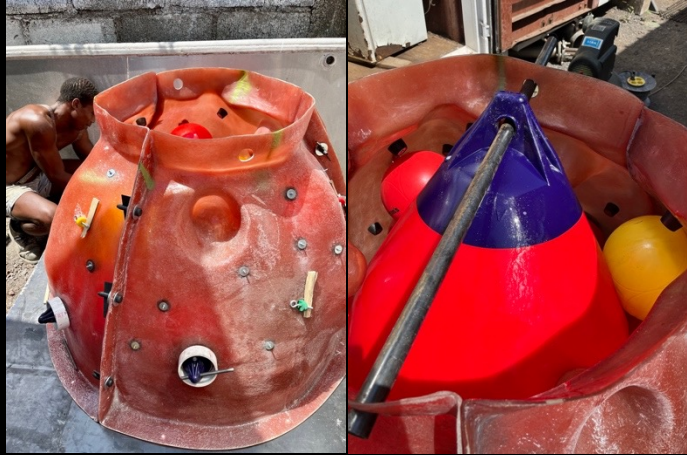
Moulage et démoulage du béton - Moulding and demoulding concrete
