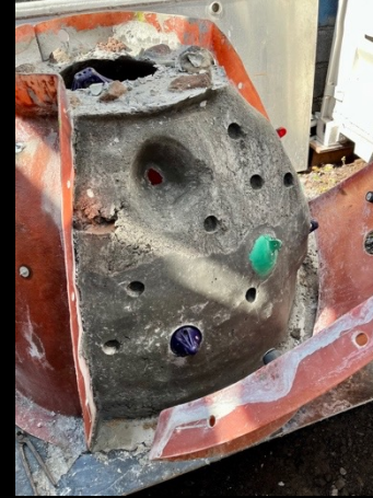
Moulage et démoulage du béton - Moulding and demoulding concrete
