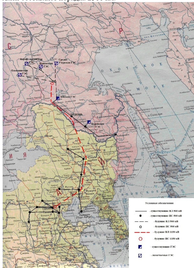
Рис. 3. Электрическая связь ЮЯГЭК – Северная энергосистема Китая
