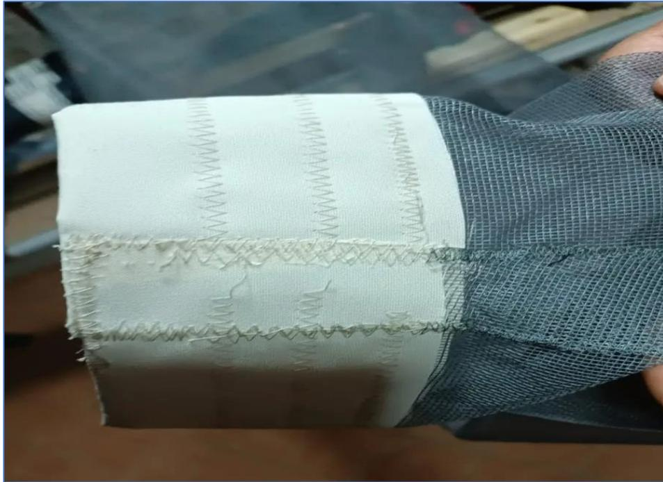
*Figura 9. Dettaglio sulla cucitura della coda finale.*
