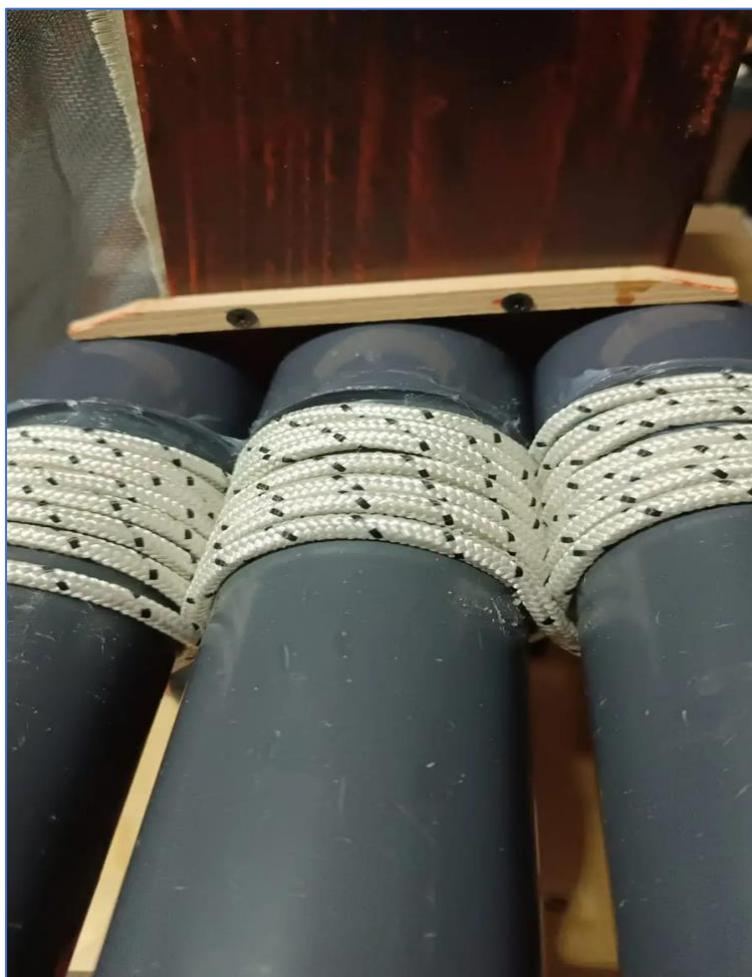
Figura 6. Il fissaggio dei tubi delle ali con le cime.
