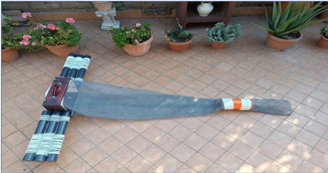
*Figura 10. La LADI finita. Si noti l'inclinazione posteriore verso il basso dell'ala sinistra di circa 7 gradi, per permettere alla LADI di rimanere a galla.*
