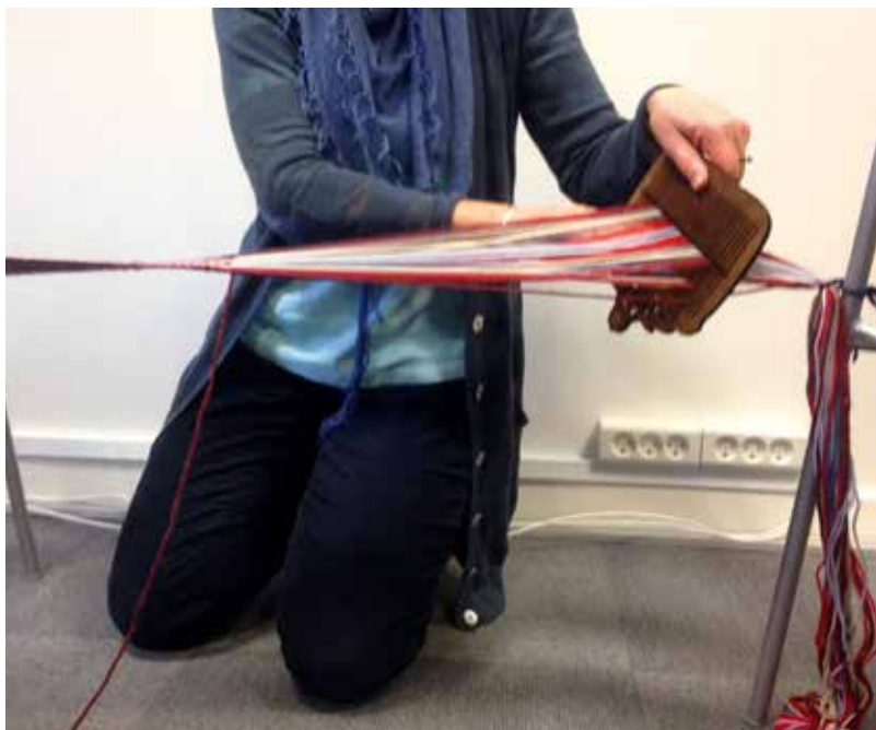
Fig. 18 Esperienza con un telaio a pettine liccio presso il CTR – Università di Copenhagen (Foto: F. Carraro 2015) Rigid heddle experience at CTR – University of Copenhagen (Photo: F. Carraro 2015)
