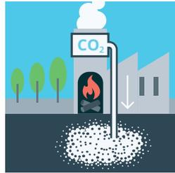
**Cattura del CO<sub>2</sub> nei camini (BECCS):** le piante trasformano il CO<sub>2</sub> in biomassa, che bruciando fornisce energia. Il CO<sub>2</sub> liberato durante la combustione è catturato e immagazzinato nel sottosuolo.
