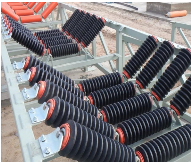
Rezina qoplamali konveyer roligi va barabani
