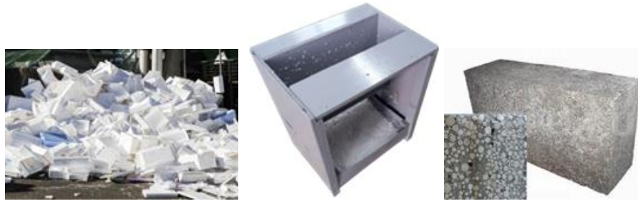
1-rasm: polistrol betonni sanoat chiqindilaridan olish texnologik sxemasi
