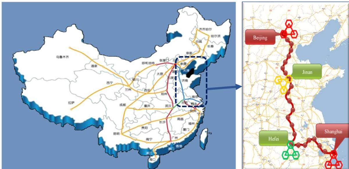
Figure 60: A droite : Liaison QKD fibre optique 1200km Shanghai-Pékin, 32 nœuds de confiance
