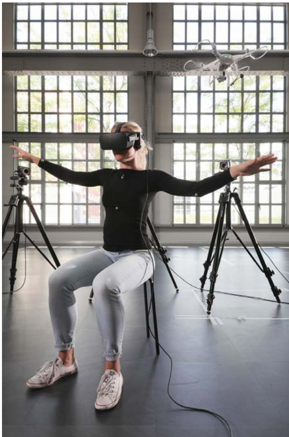
Abbildung 6: Bioelektronische Jacke zur intuitiven Steuerung von Drohnen, die an der EPFL entwickelt wurde (Foto zur Verfügung gestellt von Media Library, EPFL)
