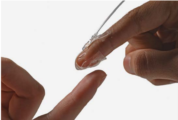
Abbildung 4: Entwicklung einer drucksensiblen künstlichen Haut, die künftig ggf. in der medizinischen Rehabilitation, aber auch zur Unterstützung virtueller Realitäten eingesetzt werden kann, am Reconfigurable Robotics Lab (RRL) und am Laboratory for Soft Bioelectronic Interfaces (LSBI) der EPFL (Foto zur Verfügung gestellt vom Center for Neuroprosthetics, EPFL)
