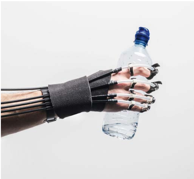
Abbildung 9: Hand-Exoskelett, eine gemeinsame Entwicklung des Defitech Foundation Chair in Brain-Machine Interface (CNBI) und der BioRob Laboratories an der EPFL (Foto zur Verfügung gestellt vom Center for Neuroprosthetics, EPFL)
