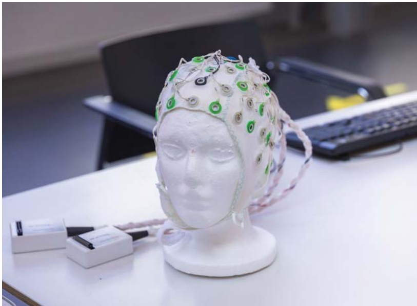
Abbildung 8: Mit Elektroden besetzte Haube zur Messung von EEGs (Foto zur Verfügung gestellt vom Center for Neuroprosthetics, EPFL)
