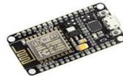
Fig. 5. ESP8266 NodeMCU.
