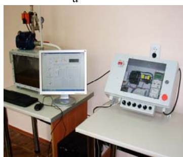
Рис. 1. Лабораторний стенд для дослідження режимів роботи відцентрових насосів: а - загальний вид лабораторного стенда; б - функціональна схема лабораторного стенду: 1 - персональний комп'ютер; 2 - магістраль USB; 3 - перетворювач RS-485/USB; 4 - магістраль RS-485; 5 - допоміжний контролер; 6 - цифровий мультиметр Socomec Digis A10; 7 - привод змінного струму ABB ACS-355; 8 - асинхронний двигун привода насоса; 9 - насос PK60; 10 - кран з сервоприводом Belimo TR-24-SR; 11 - датчик витрати рідини Sea YF-S201; 12 - датчик тиску рідини Dwyer 628CR-90; 13 - резервуар; 14 - вода; 15 - трубопровід
