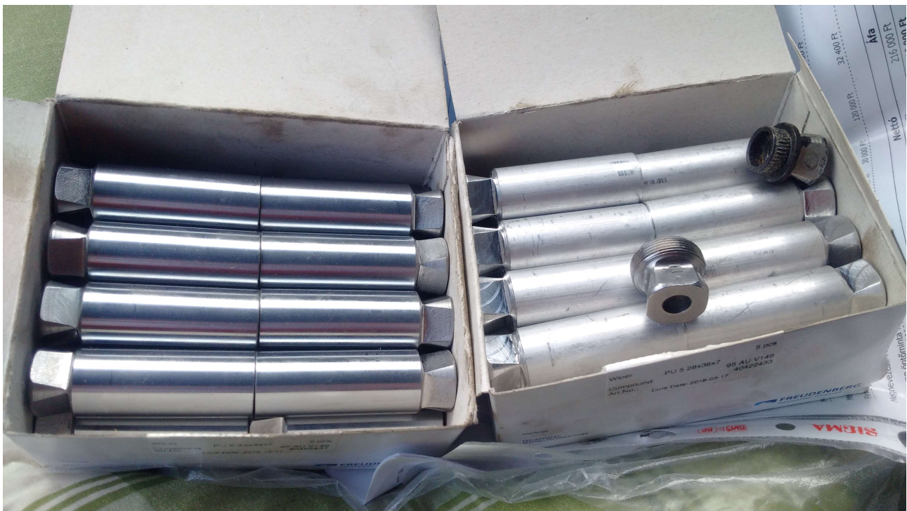
Mechanikai vizsgálatra előkészített acél és alumínium munkadarabok.
