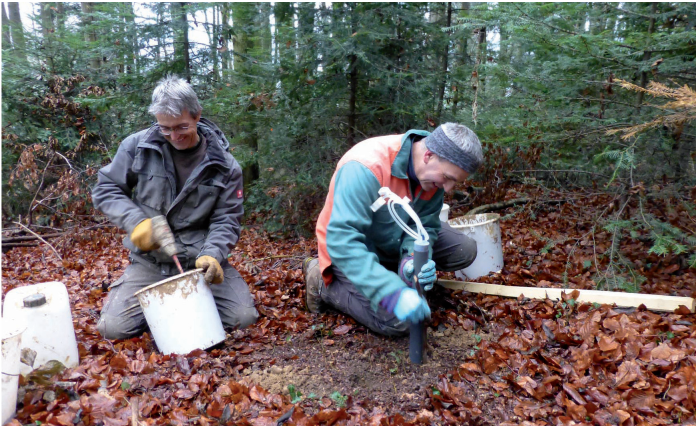
Setzen von Lysimetern (Wangen SZ)
