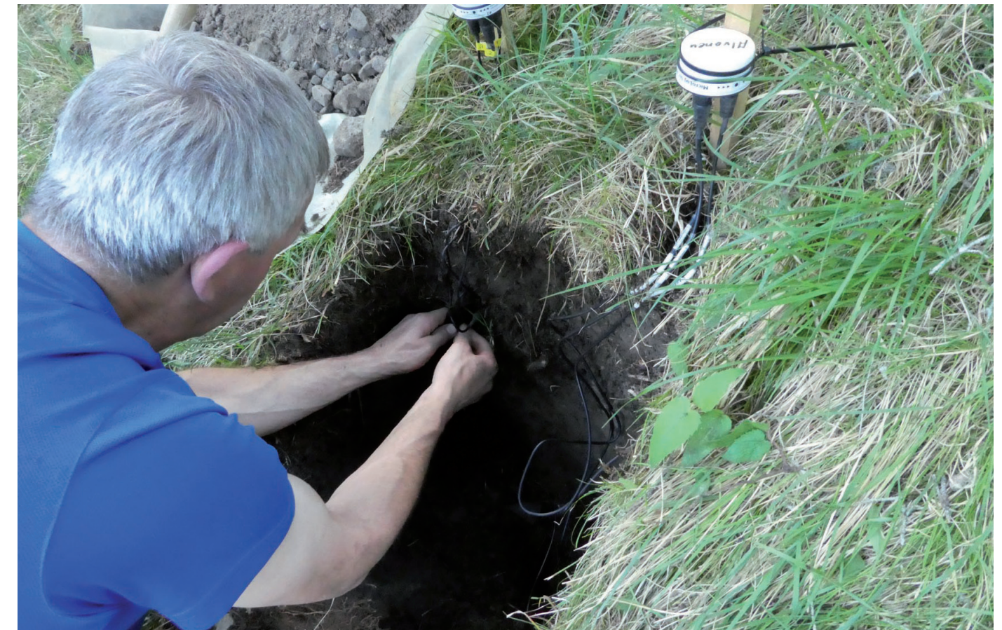
Setzen von Bodenwassersonden.
