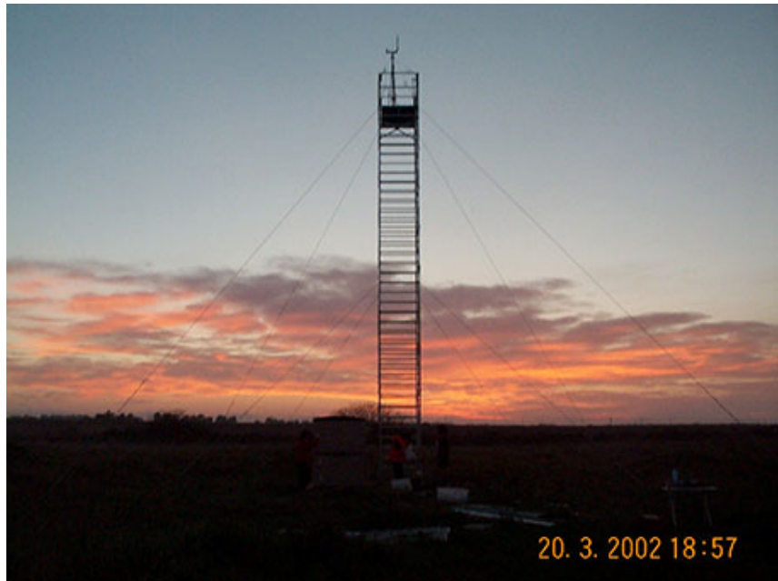
Fig. 2 - La torre di eddy covariance installata nel 2002
