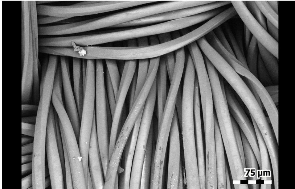
Kuva 7. Polyesterikuituja, jotka on kudottu yhteen. Mittatikku 75 \mu\text{m} . Kuitujen läpimitta n. 20 \mu\text{m} , joka vertautuu ohuimpiin hiuksiin, joiden paksuus on 10–40 \mu\text{m} . 303 Kuvatun kohteen leveys ja pituus n. 0,51 x 0,37 mm. E. P. Vicenzi/Smithsonian's Museum Conservation Institute, NIST/Handout via REUTERS, 2021 301
