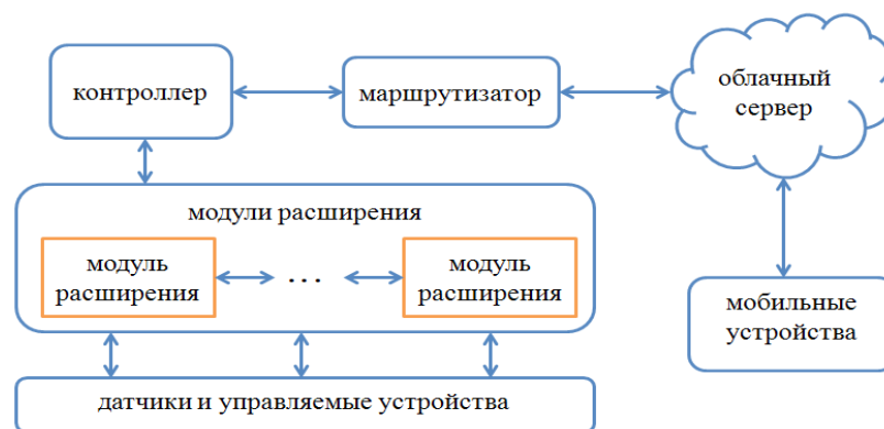
Рис. 2. Схема технического обеспечения интеллектуального производственного здания с функцией удаленного управления при помощи глобальной сети Интернет
