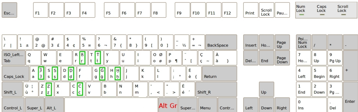
Figure 2: Exemple d'agencement de clavier. Ceci est le clavier QWERTY, on peut y voir le jumelage entre touche usuelles et nouvelles touches (encadrées en vert). La touche Altgr est celle en rouge ; on accède aux nouvelles touches en la maintenant enfoncée.
