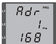
Fig.: TCP/IP address, byte 1
