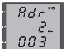
Fig.: TCP/IP address, byte 2, value 003
