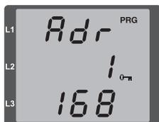
Fig.: TCP/IP address, byte 1, value 168
