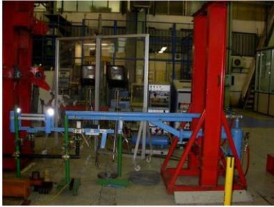
**Fig. 6.** Hail impact test
