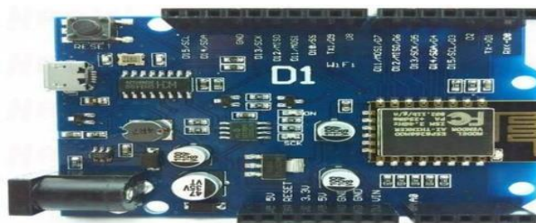
Figure 3: Arduino Wemos D1 R2 Microcontroller
