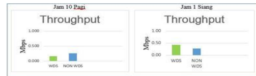
Gambar 4 Grafik QoS Nilai Throughput Kondisi Streaming Hari ke 1
