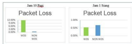
Gambar 8 Grafik QoS Nilai Packet Loss Kondisi Unduh Hari ke 1
