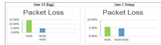
Gambar 5 Grafik QoS Nilai Packet Loss Kondisi Streaming Hari ke 1
