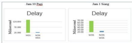
Gambar 3 Grafik QoS Nilai Delay Kondisi Streaming Hari ke 1
