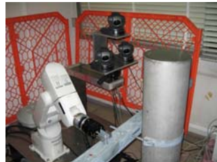
(d) MoveFC (inserting the bolt)
