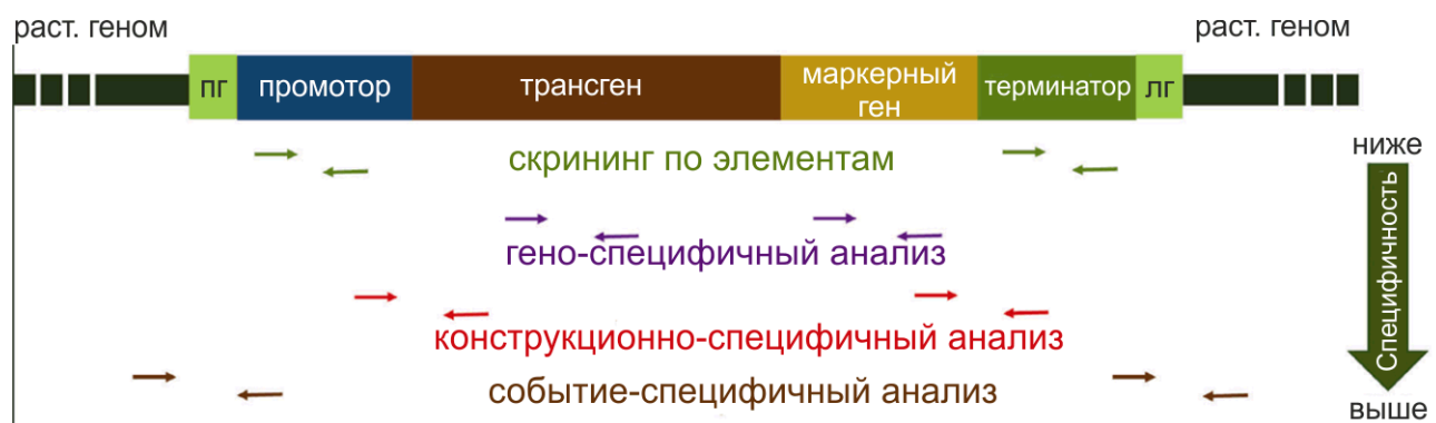
Рис. 13. Схема трансгенной конструкции, используемой при трансформации линии культурного растения, мишени для идентификации ГМИ и уровни анализа в зависимости от анализируемых мишеней. Позиции праймеров, используемых в различных уровнях, отмечены стрелками соответствующего цвета. Обозначения «пг» и «лг» - правая и левая границы встраиваемой в растительный геном конструкции, соответственно.
