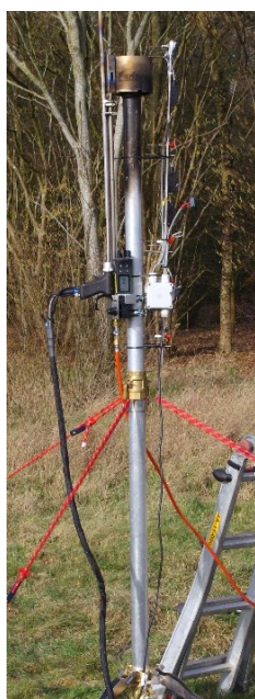
Figuur 3 De brander van de fakkel met de aanzuigleiding van rookgassen (rode pijl) en Figuur 4 en Figuur 5 De brander van de fakkel met de toegevoegde vonkontsteker (gele pijl).
