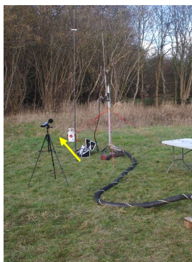
Figuur 7 De Brüel & Kjaer geluidsmeter en de positie in de meetopstelling (gele pijl).
