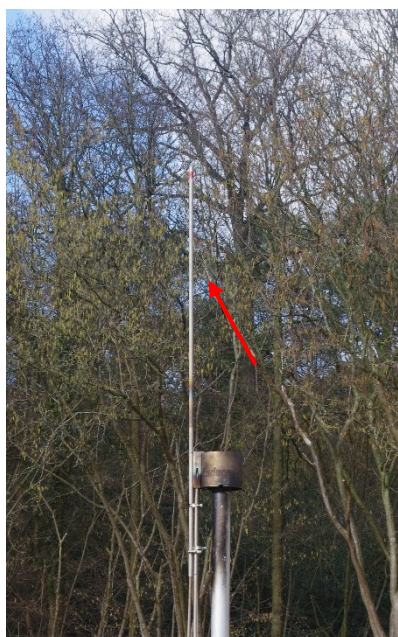
Figuur 3 De brander van de fakkel met de aanzuigleiding van rookgassen (rode pijl) en Figuur 4 en Figuur 5 De brander van de fakkel met de toegevoegde vonkontsteker (gele pijl).
