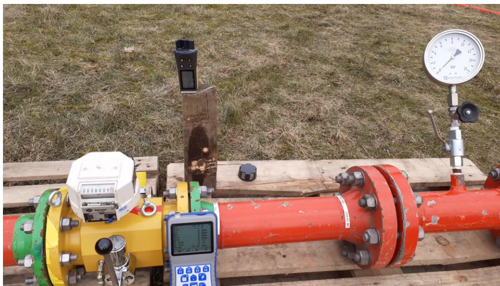
Figuur 6: Debietmeter (Links, geel), Drukmeter (rechts), Anemometer (midden boven), Uitlezer rookgasgasanalyse (midden onder)
