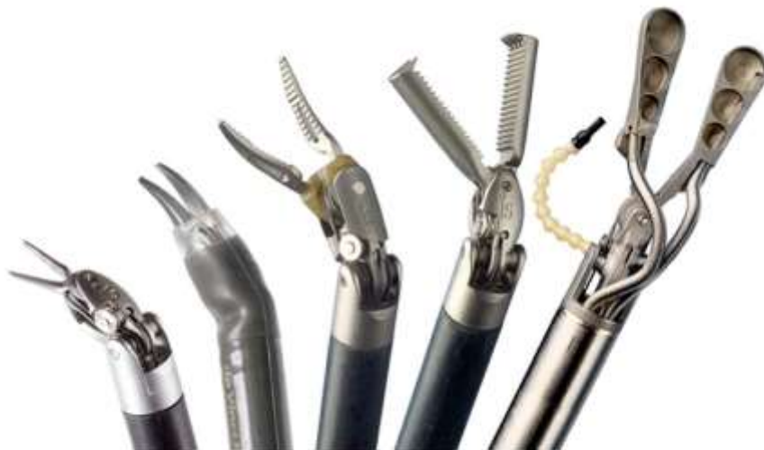
Figura 12 – Exemplos de pinças específicas do robô da Vinci para cirurgias robóticas
