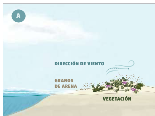
Figura 1. Esquema de la formación de dunas costeras progradante o creciente, en las que la vegetación funciona como obstáculo. A) Interrupción del movimiento de arena por raíces y tallos de plantas; B) Acumulación de arena a causa de las raíces y los tallos enterrados de plantas pioneras; C) Aumento en acumulación de arena formando una elevación; estabilización del sedimento por aumento de cobertura y altura de vegetación; D) Desarrollo de cordones de dunas tierra adentro de manera paralela a la primera acumulación de arena.
