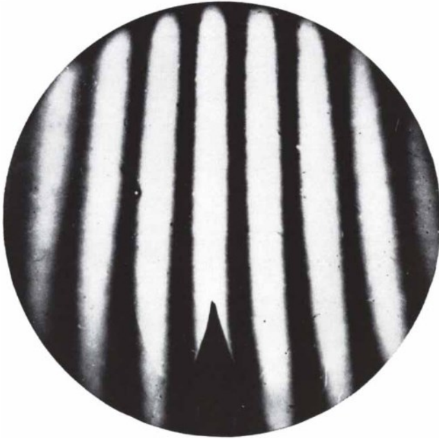
Fig. 8. Fotografia do padrão de interferência observado pela luneta do interferômetro de Michelson (Shankland, 1964b, p. 110).
