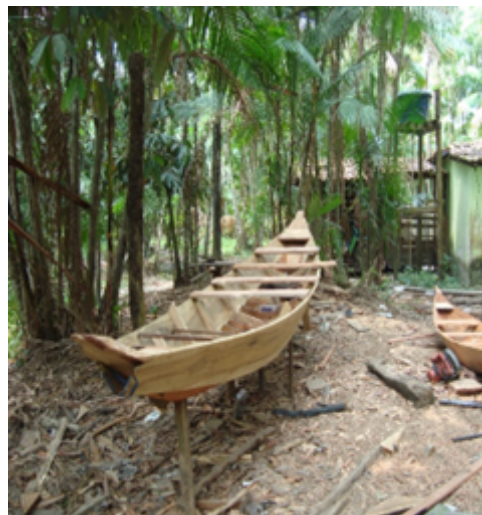
Figura 5 - Construção artesanal de canoa usada pelos ribeirinhos
