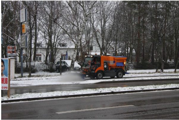
Abbildung 1. Schmalspurfahrzeug mit Frontkehrbesen auf einem Radweg
