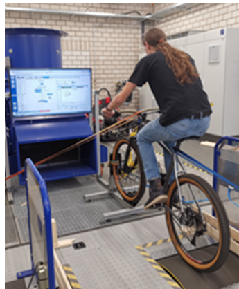
Abbildung 1. Messung mit einem Fahrrad auf dem Rollenprüfstand
