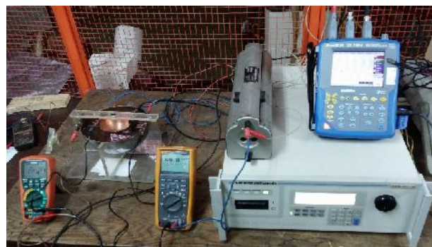
Slika 3 – Prikaz baždarenja mernog sistema
