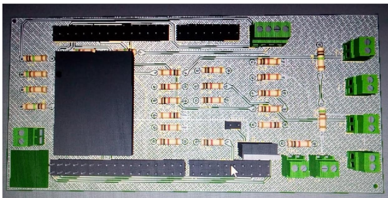
Ilustración 13 Shield de Xbee con acoplamiento de sensores de corriente y voltaje.
