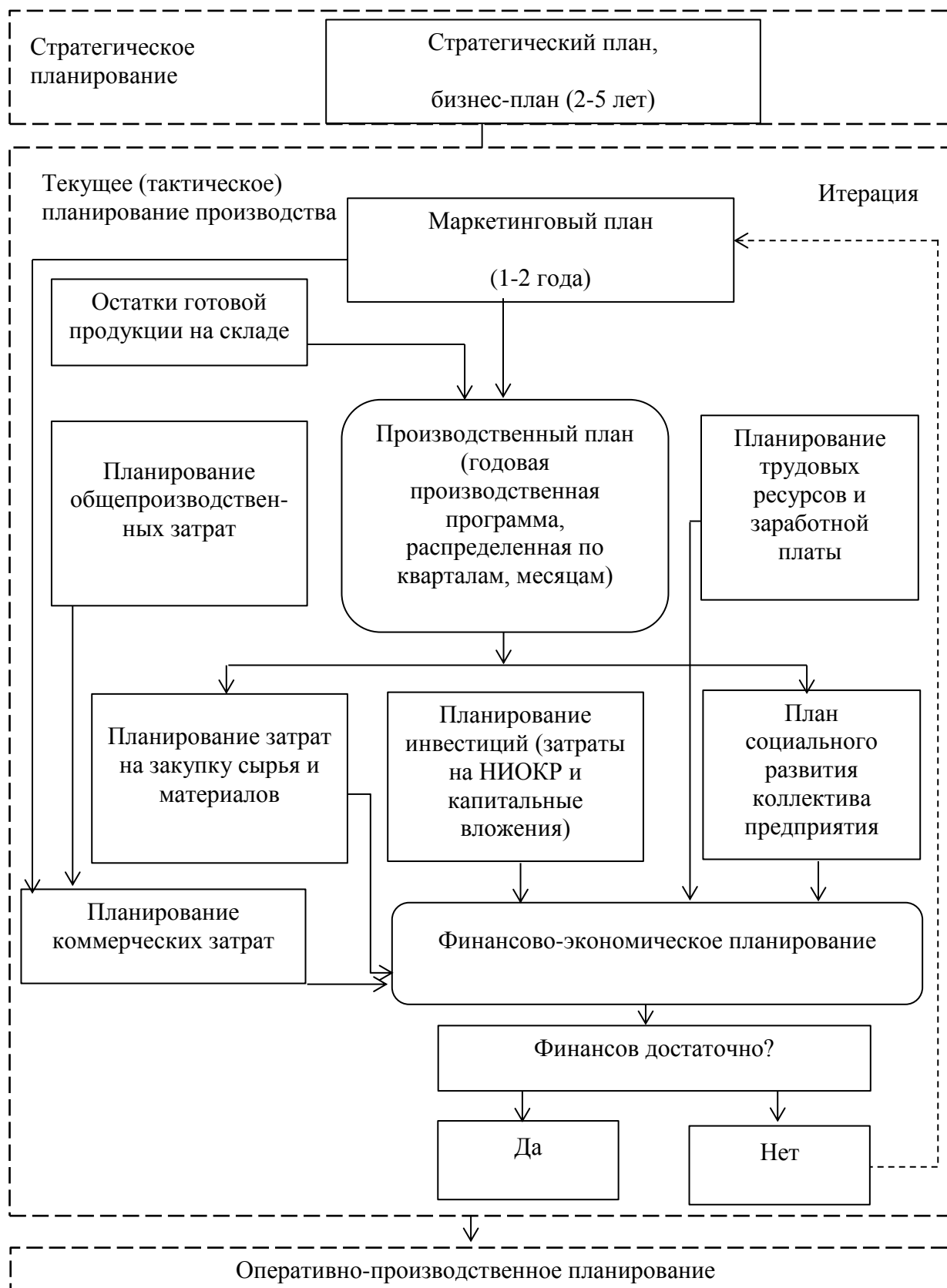
Рисунок 1 – Роль и место внутреннего производственного планирования в системе планирования компании
