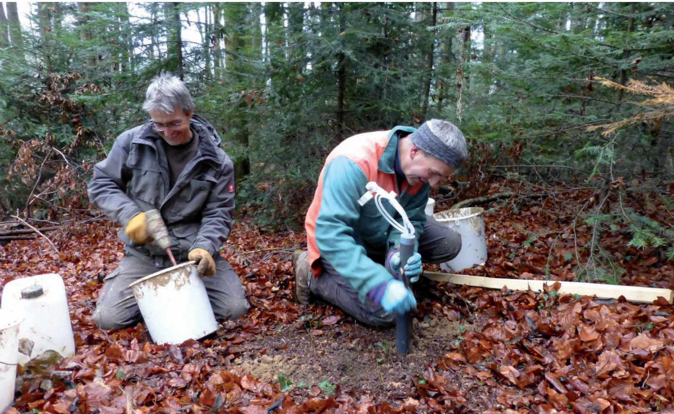
Setzen von Lysimetern (Wangen SZ)
