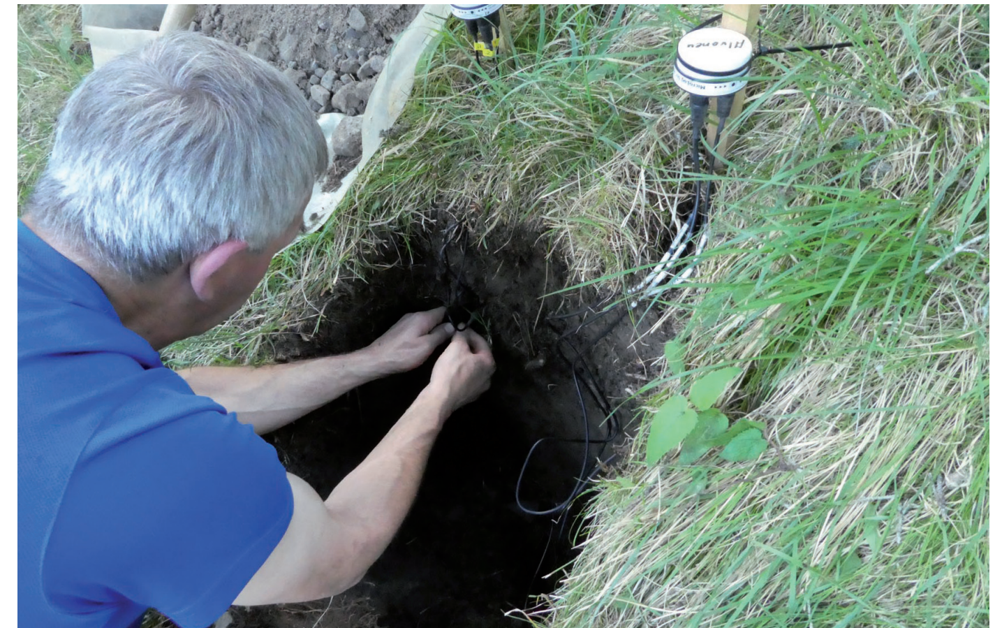
Setzen von Bodenwassersonden.
