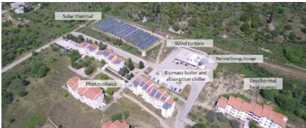
Εικόνα 1: Αέρια φωτογραφία του κτιριακού συμπλέγματος των εστιών των Κιμμερίων Ξάνθης. Φαίνονται, από πάνω αριστερά, το ηλιοθερμικό πεδίο και το ενεργειακό κέντρο που περιέχει τα TES και τον λέβητα βιομάζας [12].
